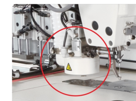
激光切割，适配复杂图案 Laser cutting for complex patterns
