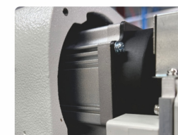
主轴伺服电机 Spindle servo motor
